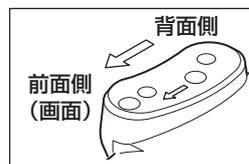
スタンドの上部の刻印などから、取り付ける方向を確認する
